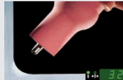
Tungsten uç çapı: 1 mm Temel işlem maddesi: AIMg3 Malzeme kalınlığı: 5 mm Kaynak akımı: 185 A Kaynak gerilimi: 15,6 V AC Balans: -5
