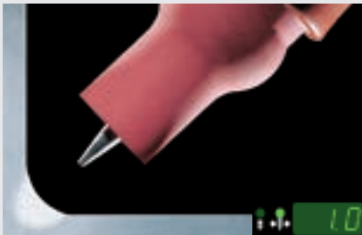
Tungsten uç çapı: 1 mm Temel işlem maddesi: AIMg3 Malzeme kalınlığı: 5 mm Kaynak akımı: 185 A Kaynak gerilimi: 15,6 V AC Balans: -5
